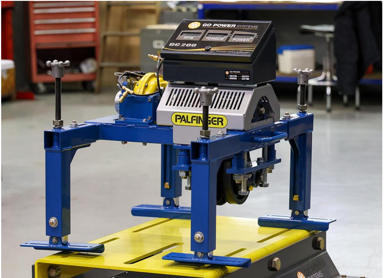
Der neu entwickelte PALFINGER Go Power D100LE („Dyno“), ein Motorprüfstand für Rettungsboote. © PALFINGER
